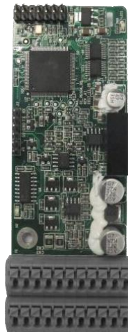
Простая PG-плата 24 В EC-PG507-24
