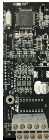
Простая PG-плата 24 В EC-PG507-24
