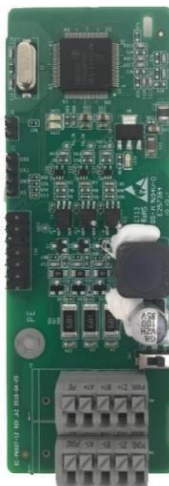
Простая PG-плата EC-PG507-12
