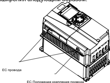
Рис А.5 Прокладка проводов для платы расширения
