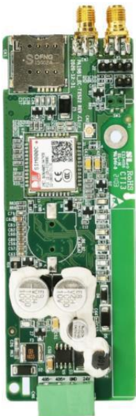
GPRS плата EC-IC501-2
